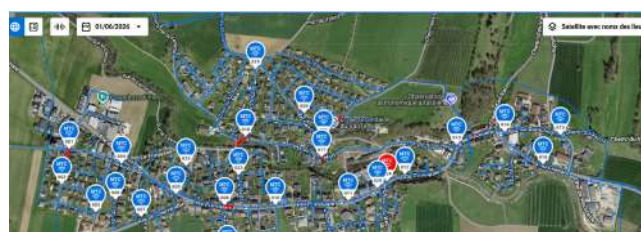
Exemple Vicques | Emplacement des capteurs. En rouge : une anomalie potentielle détectée, à vérifier par le fontainier.
